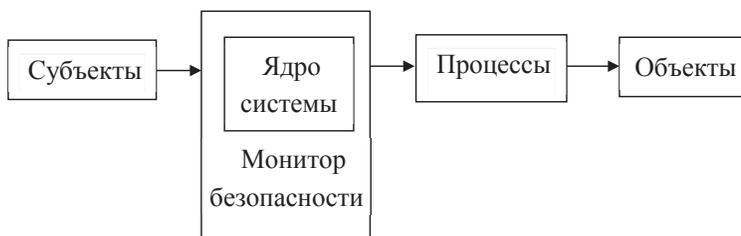
Рис. 7.2. Защищенная система
