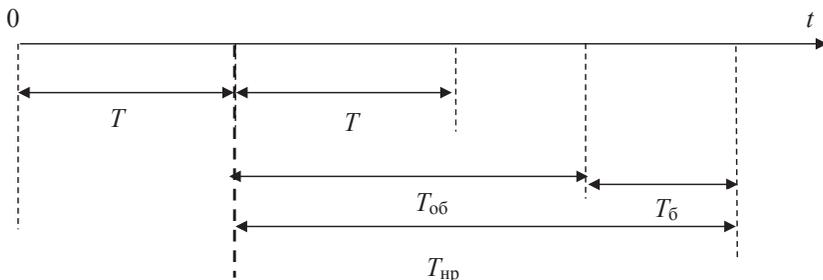
Рис. 4.2. Временная диаграмма процесса контроля и обнаружения НСД:
